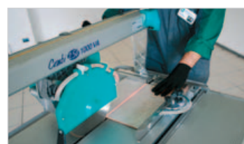
Puntatore laser di serie
