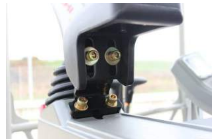
Braccioli regolabili con viti di registrazione disposte posteriormente.
