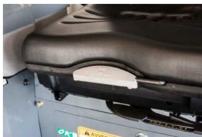
Sedile Deluxe in PVC (versione Tettuccio) con tre possibilità di regolazione e cintura di sicurezza retraibile.
